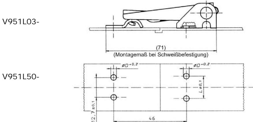
Loch-  $\varnothing$  und Abstand L entsprechend der Gegenhaken- und Spannverschluss-Ausführung wählen.
