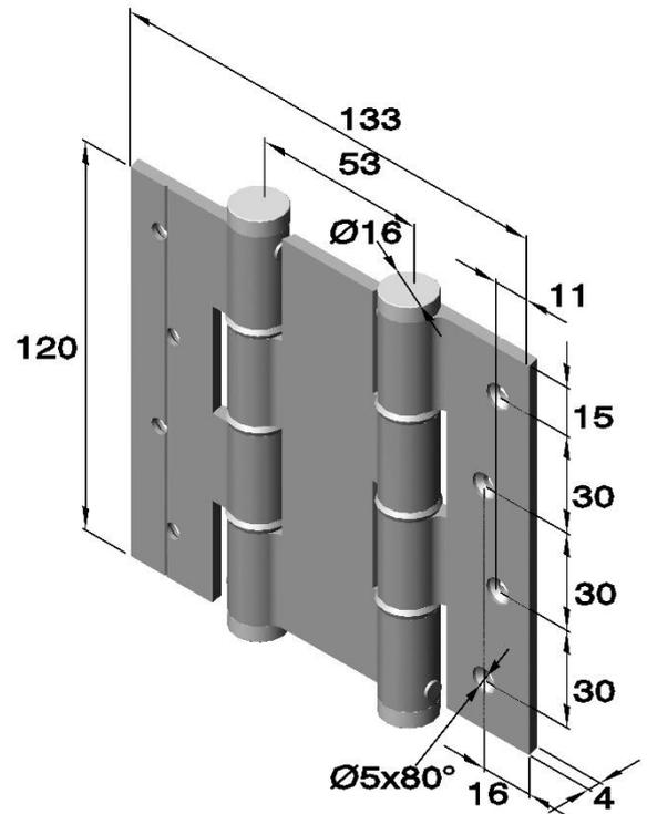
Art.Nr. 158. 5914. \_\_. \_\_ (Federkraft einstellbar)
