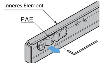
Wenn Sie den Inbusschlüssel im Uhrzeigersinn drehen, wölbt sich der PAE in Pfeilrichtung, was das Rasseln beim Schließen verringern und den Druck auf den offenen Bereich ausdehnen kann.
