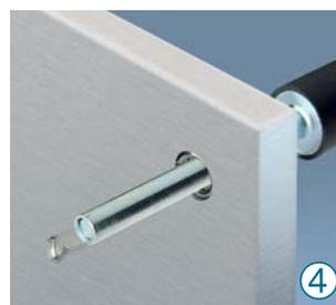
Im letzten Schritt wird der Zapfen mit dem Zapfenbrecher abgebrochen.
