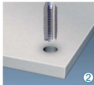
Anschließend wird in Schritt zwei in das neu gebohrte Loch ein Gewinde mit dem Gewindeschneider geschnitten.
